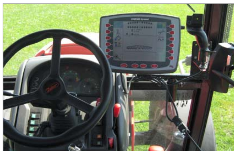
Jeden monitor + joystick v kabině = snadné ovládání
