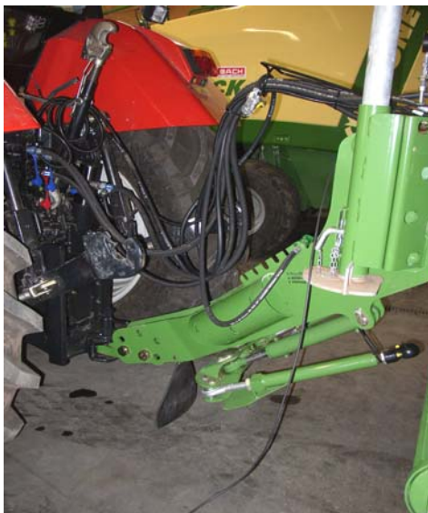
Spodní zavěšení má smysl. Oj je však krátká. Vadí to u traktorů s velkým rozchodem kol.
