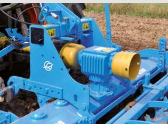
Jednoduché přenášení síly přes převodovku
