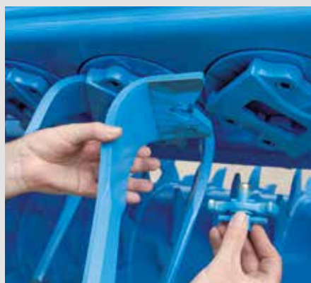
Výměna rychloupínacích nožů
