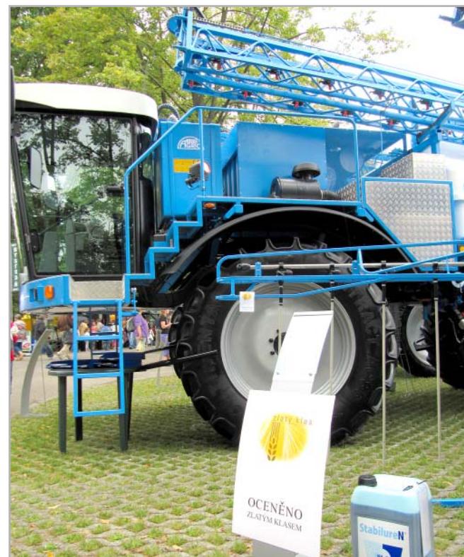
Obr. 1 - Nový technologický postup při aplikaci kapalných hnojiv byl oceněn vloni hlavní cenou Zlatý klas na výstavě Země živitelka. Tento postup je založen na využití aplikačních trubic umístěných na postřikovači ve vzdálenosti 25 cm, z nichž vytéká kapalné hnojivo mezi řádky (ob řádek) na povrch půdy. Výhodou je, že hnojivo se neaplikuje na rostliny a posklizňové zbytky a je i při vyšších dávkách dusíku minimalizováno riziko popálení porostu a ztrát dusíku únikem amoniaku
