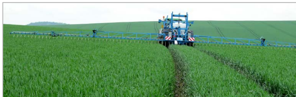
Obr. 2 - V praxi se osvědčilo založení porostů obilnin plošným setím do patnácticentimetrových pásů s mezerami deset centimetrů, kterými pak projíždějí aplikační trubice
