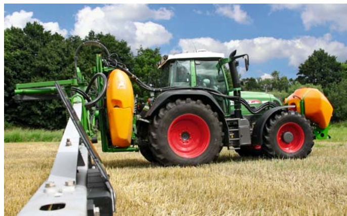
Čelní nádrž slouží jak ke zvětšení objemu nádrže, tak i jako přední zátěž.
